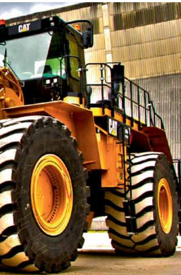
CAT-Gigant: Der Radlader 992 K ist bei der Heidelberger Zement AG mit langzeittauglichen und biologisch abbaubaren Panolin-Ölen im Einsatz. Das Hydraulik- und Motorenöl wird im By-Pass mit Kleenoil-Microfiltration zusätzlich filtriert. Die Ölqualität wird mit dem Kleenoil-ICC-Sensor überwacht.
