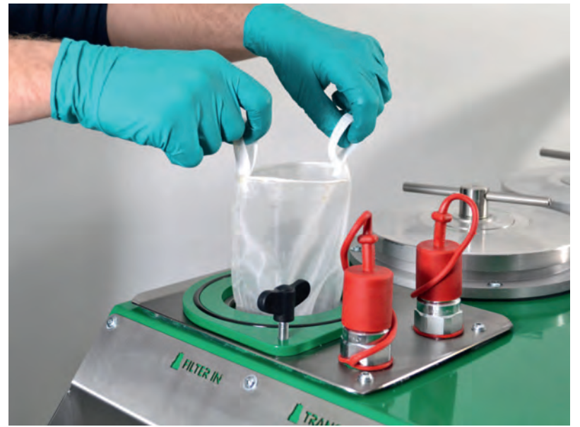
Auswaschbare Vorfilter schützen die Pumpe und schonen die Feinfilter.
