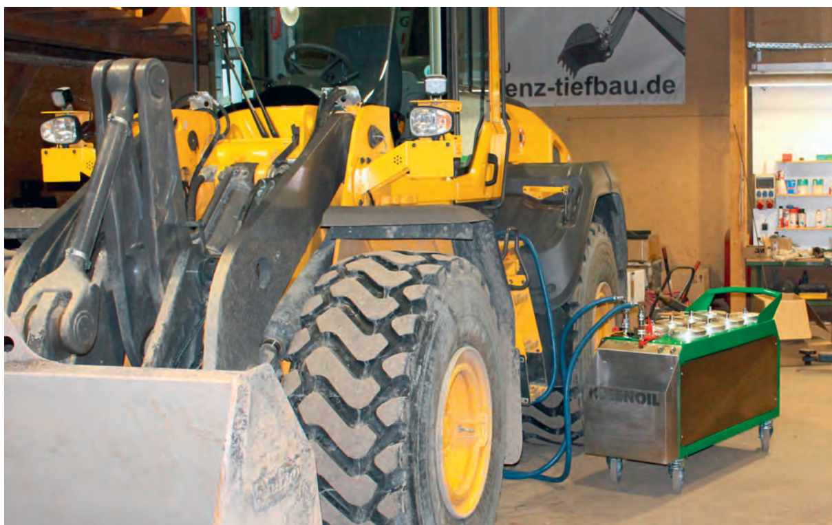
Die mobile Filteranlage wurde unter anderem konzipiert, um im Werkstatteinsatz unterschiedliche Ölsorten zu warten. Bilder: Kleenoil
