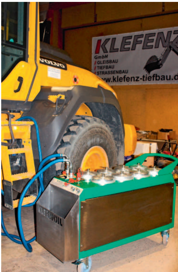
KLEENOIL 8S-100-D: Ideal für den Werkstatteinsatz, um damit die unterschiedlichsten Ölsorten zur warten.
