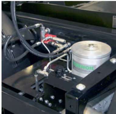
Die Mikrofiltration geschieht im Nebenstrom, wobei auf diese Weise selbst Kleinstpartikel bis zu 1 µm und Wasser ausgefiltert werden. Deshalb muss die Hydraulikflüssigkeit in aller Regel auch während der gesamten Nutzungsdauer der Wechselbrückenhubwagen nicht erneuert werden.
