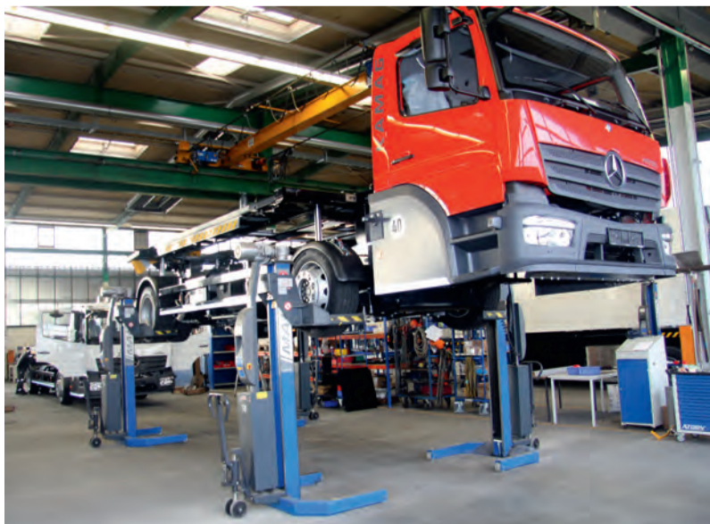
Die Wechselbrückenhubwagen (Wiesel), hier bei der Endkontrolle, sind für den internen Transport von Wechselbehältern aller Baugrößen sowie Sattelanhängern und Anhängern konzipiert.
