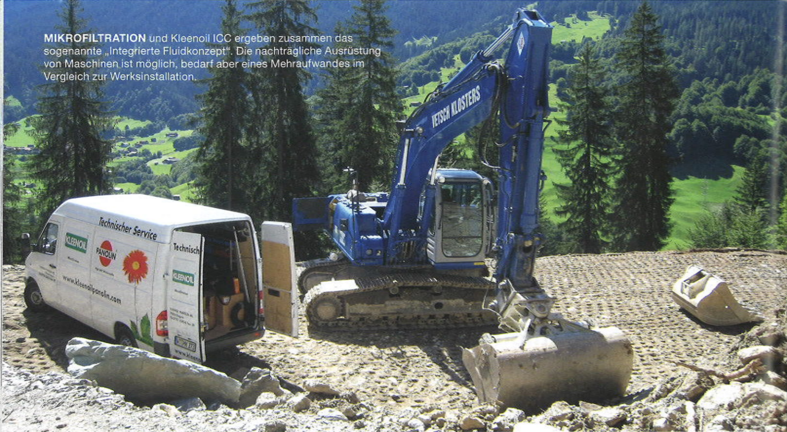
IM KOMPLEX WIRKSAM: Bei Maschinen mit mehreren Hydraulikkreisläufen muss jeder Kreislauf mit der Nebenstromfiltration und Kleenoil ICC separat ausgestattet werden. Fotos: Kleenoil Panolin
