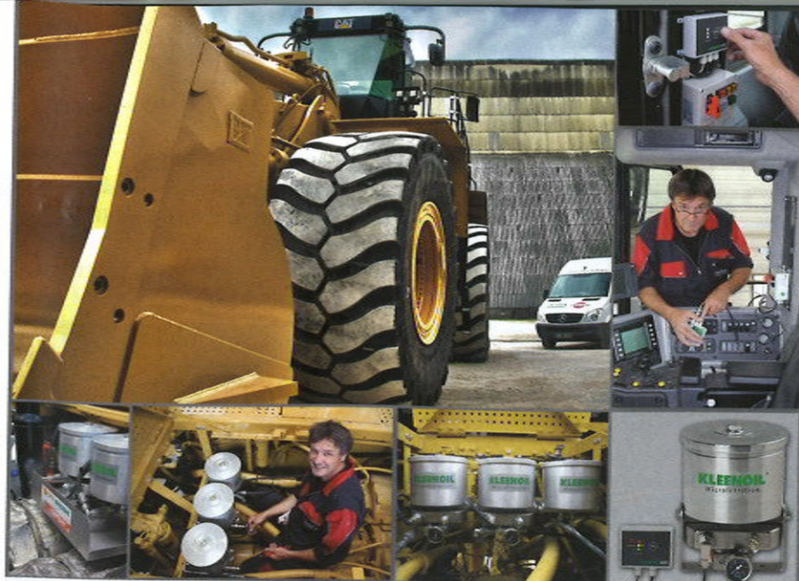
IM KOMPLEX WIRKSAM: Bei Maschinen mit mehreren Hydraulikkreisläufen muss jeder Kreislauf mit der Nebenstromfiltration und Kleenoil ICC separat ausgestattet werden. Fotos: Kleenoil Panolin
