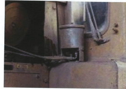
INNERER WERTERHALT: Kleenoil-Nebenstromfiltration im Einsatz in einem Tagebau in Ex-Jugoslawien. Das Alter der Maschine ist unverkennbar. Die Kleenoil-Mikrofiltration bewahrt dennoch ihre Leistungsfähigkeit.
