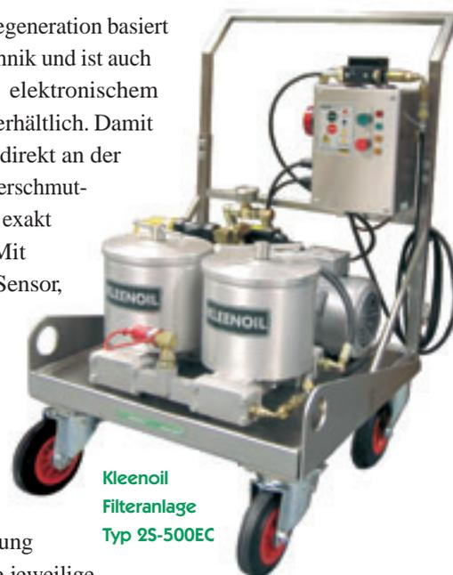
Kleenoil Filteranlage Typ 2S-500EC
