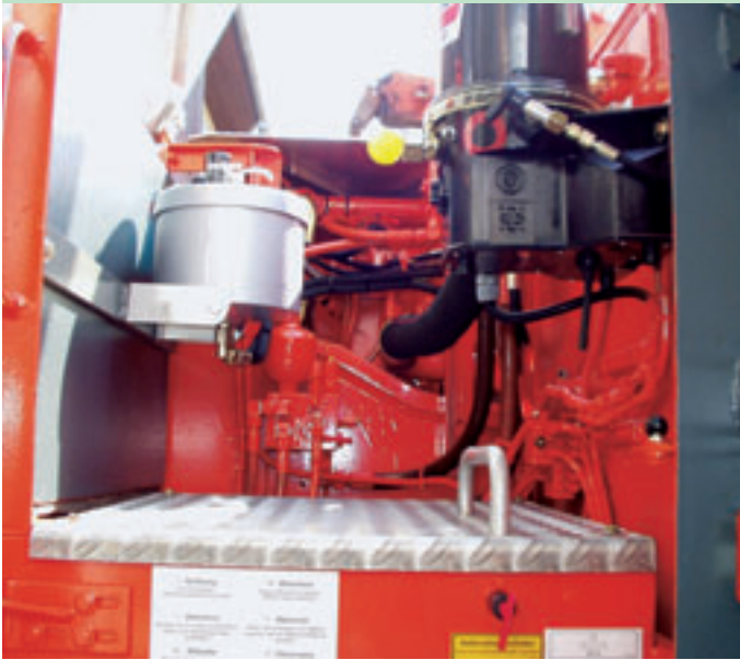
Fest montierter Nebenstromfilter auf einem Atlas Terex 1804 LC
