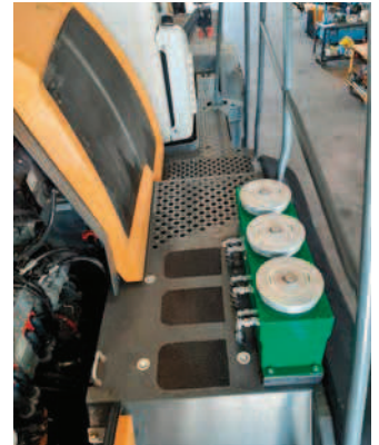
Die Microfiltration mit Kleenoil Nebenstromfilter für alle Öl-Haushalte einer Maschine (Hydraulikmotor und Getriebe) ermöglicht eine dauerhafte Verlängerung von allen Ölwechselintervallen.
